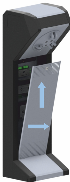
Рисунок 7.4.2 – Демонтаж центральной панели
